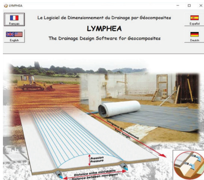
Fig. 3 - Apa care intră în stratul de drenaj este drenată către miniconducte și este evacuată prin acestea în șanțul colector sau conducta principală de evacuare.
