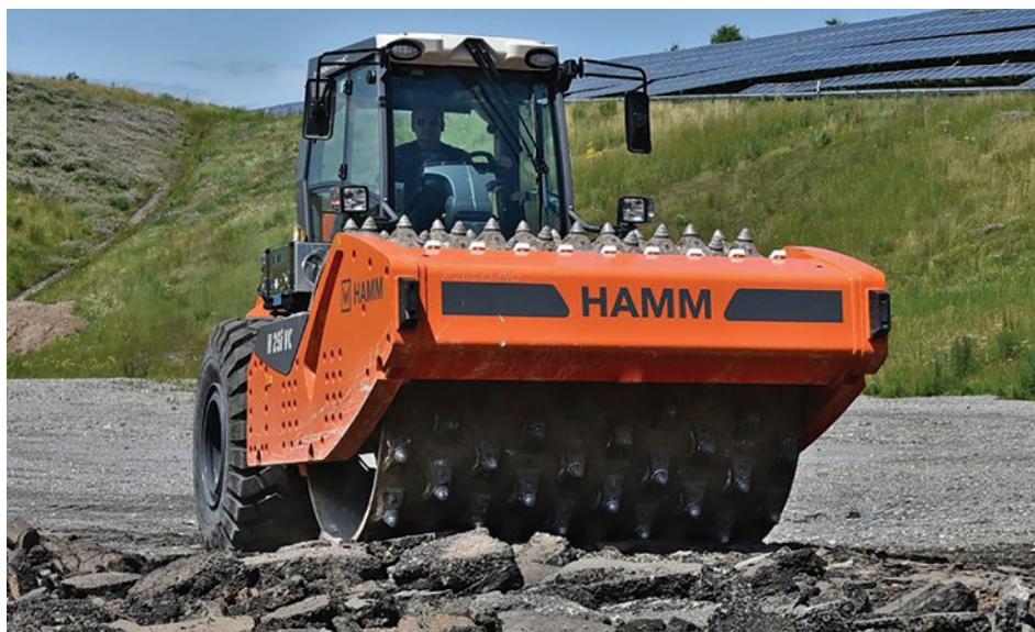
Foto 4 - Compactorul H 25i VC de la Hamm este capabil să zdrobească și sfărâ-măturile formate din materiale de construcție a drumurilor care conțin gudron, care apoi sunt depozitate la depozitul Steinmühle, fără nicio bătaie de cap.
