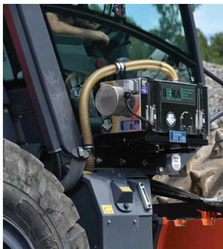
Foto 3 - Cabina modelului H 25i VC a fost echipată cu sistem de ventilație de siguranță, pentru a preveni pătrunderea particulelor dăunătoare, aflate în suspensie în aer.
