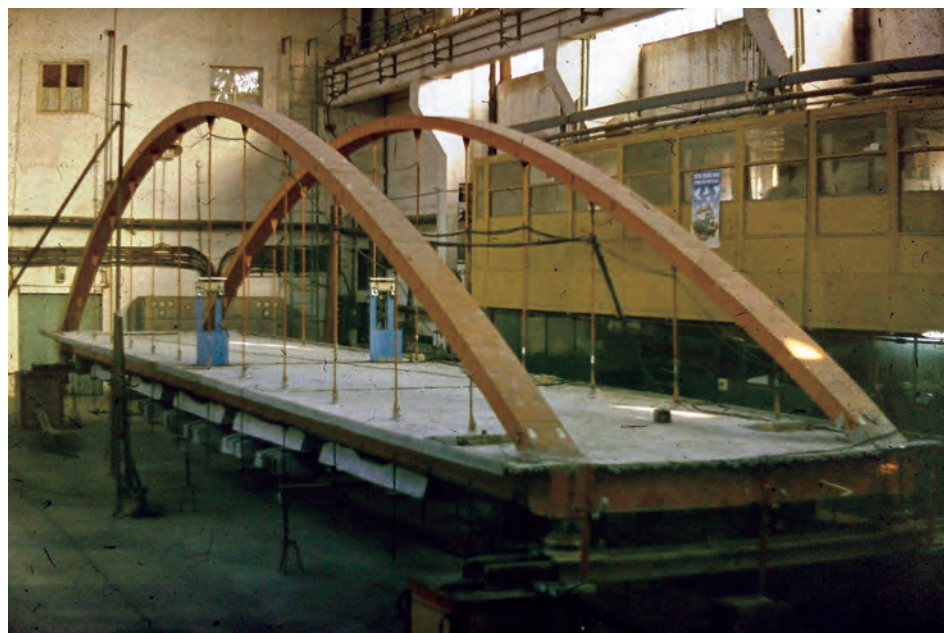
Fig. 7 - Modelul terminat și echipat, pregătit pentru testări
