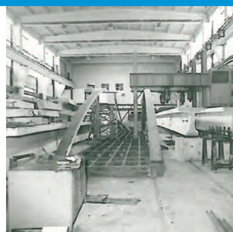
Fig. 6 - Aspect de la confecționarea modelului scara 1:6,5 în hala de încercări de la INCERTRANS
