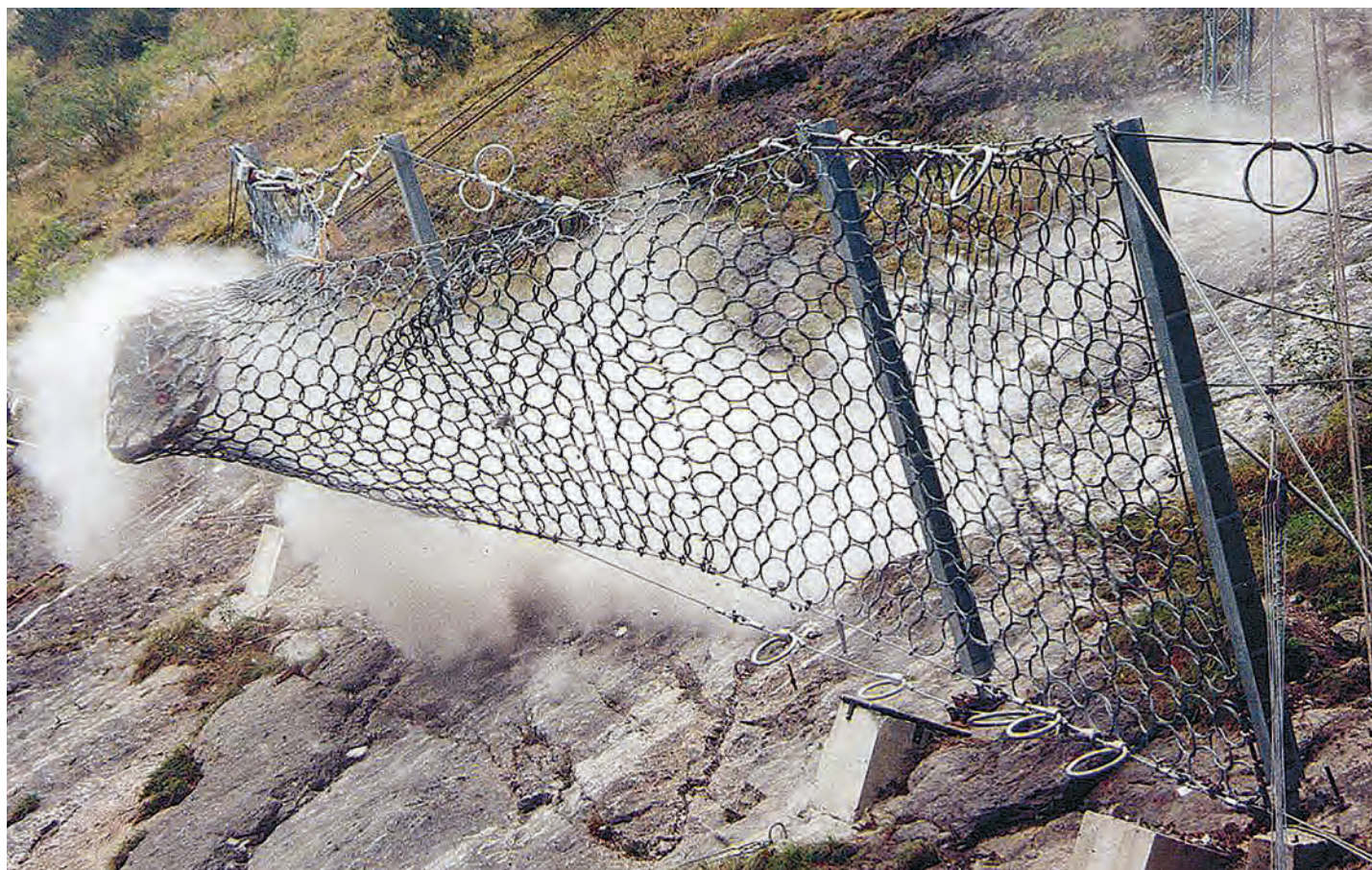
Sistemele Geobrugg sunt testate la scară 1:1
