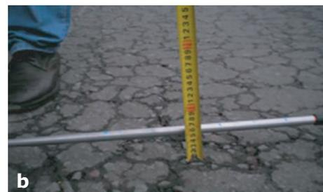
Fig. 5 a, b - Cedări structurale cu tasări și faianțări
