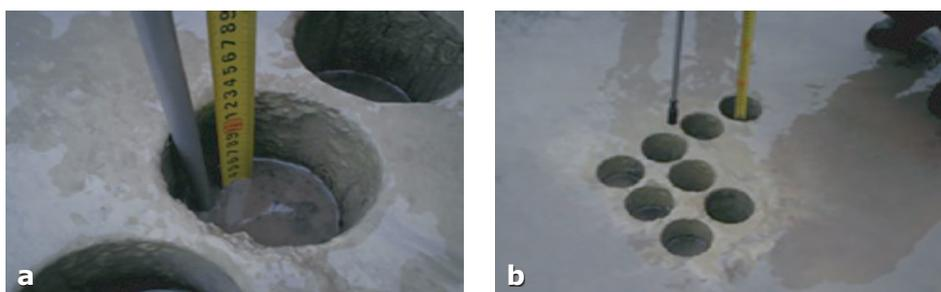
**Fig. 10 a, b - Se fac măsurători de grosime a stratului asfaltic. Pentru prelevări de probe materiale în vederea testelor de laborator, se fac mai multe carotări pe pichetul de investigare**
