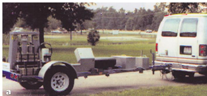
Fig 16 a, b - Evaluare a capacității portante reziduale a structurii rutiere folosind principiul remorcii FWD sau a Pârghiei Benkelman modernizate
