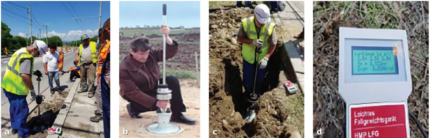
Fig 14 a, b, c, d Verificări de capacitate portantă la fiecare strat nelegat cu liant rutier și la teren de fundație
