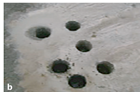
Fig. 5 a,b - Realizarea de 6 carote D100mm, sau 3 carote D300 mm, pentru a se putea preleva și materialele necesare testelor calitative de laborator
