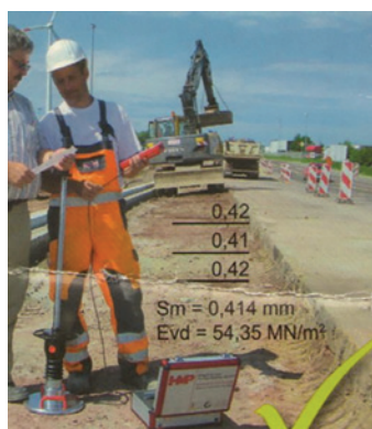
Fig. 18 a, b, c, d - Realizarea măsurătorilor de capacitate portantă la nivelul terenului de fundație al structurii rutiere
