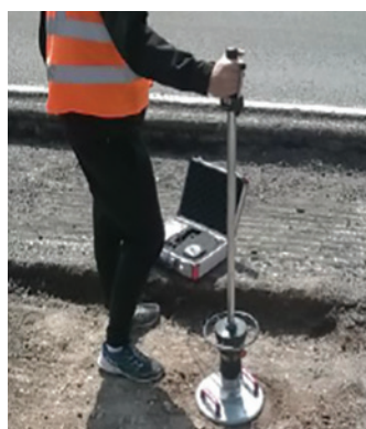
Fig. 18 a, b, c, d - Realizarea măsurătorilor de capacitate portantă la nivelul terenului de fundație al structurii rutiere
