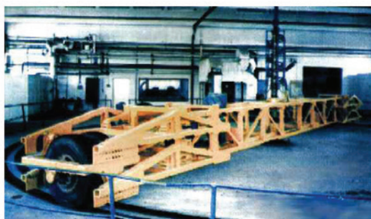
Figura 1 – Pista circulară de încercări accelerate ALT – LIRA a Universității Tehnice „Gh. Asachi”
