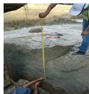
Fig. 16 a, b, c - Măsurători în cazul unor crăpături în platforma drumului
