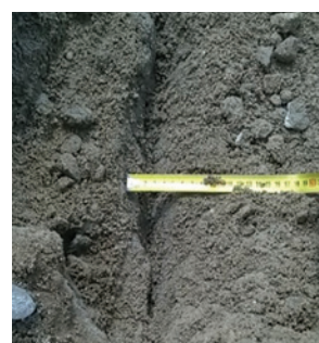
Fig. 16 a, b, c - Măsurători în cazul unor crăpături în platforma drumului
