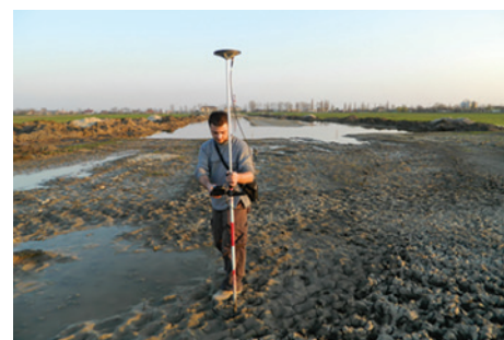
Fig. 2, 3 - Măsurători topometrice pe suprafețe degradate
