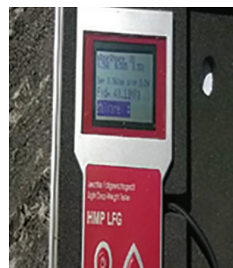
Fig. 18 a, b, c, d - Realizarea măsurătorilor de capacitate portantă la nivelul terenului de fundație al structurii rutiere
