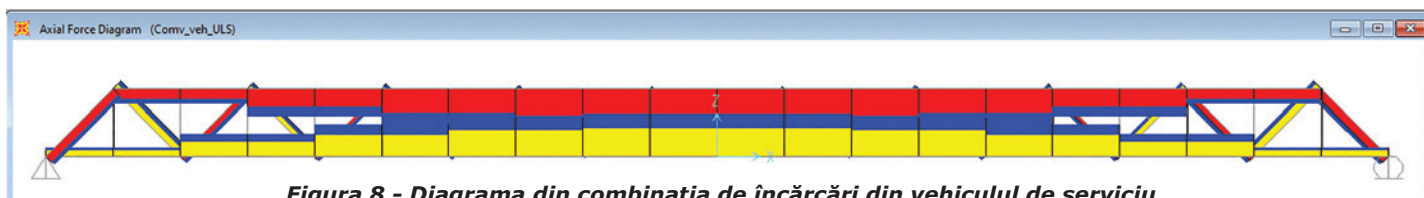
Figura 8 - Diagrama din combinația de încărcări din vehiculul de serviciu
