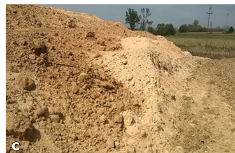
Fig. 5 a, b, c – Teren de umplură cu alcătuire structurală preponderent prăfoasă
