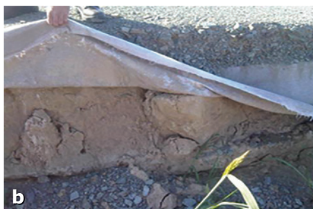
Fig. 14 a, b, c – Argila prăfoasă reține apa pluvială și în cazul asigurării cu materiale geotextile
