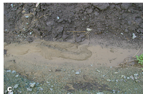
Fig. 14 a, b, c – Argila prăfoasă reține apa pluvială și în cazul asigurării cu materiale geotextile
