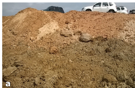
Fig. 5 a, b, c – Teren de umplură cu alcătuire structurală preponderent prăfoasă
