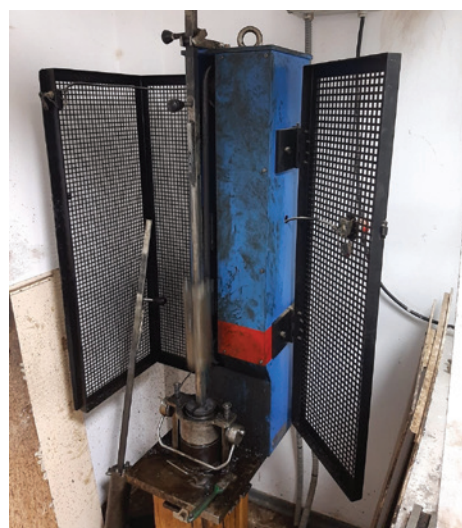
Fig. 2.1 – Compactor Marshall folosit pentru obținerea cilindrilor
