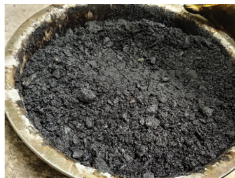
Fig. 1.4. – Anrobarea completă a agregatelor cu bitumul prestabilit conform rețetei
