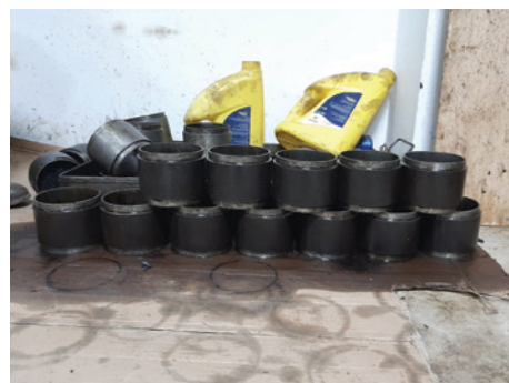
Fig. 1.5. – Pregătirea matricelor, pentru confecționarea cilindrilor Marshall
