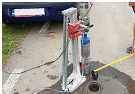
a. imagine de ansamblu a verificării grosimii straturilor structurii rutiere
