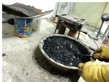
Fig. 1.3. – Amestecarea agregatelor și bitumului manual în laborator
