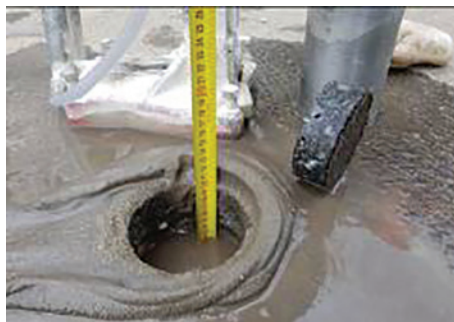
b. h_{asfalt+strat stabilizat} = 8.5cm
