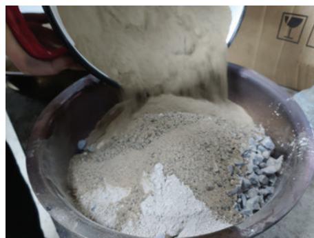
Fig. 1.1. – Amestecarea agregatelor în laborator
