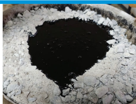
Fig. 1.2. – Adăugarea bitumului conform rețetei prestabilite
