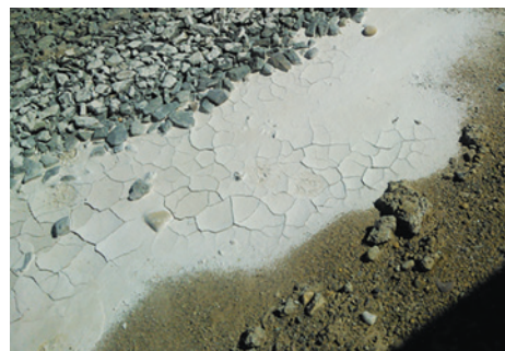
Fig. 4 - Aspectul după întărire al amestecului de apă cu diferite părți fine, rezultat în urma spălării unui automalexor. Se observă potențialul mare de contracție la uscare al acestuia
