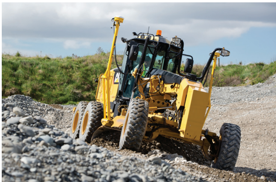
Figura 2 - Sistem de ghidare 3D cu receptoare GNSS
