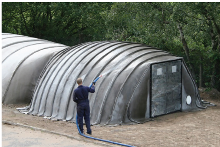
Foto 1 – Concrete Canvas a fost inițial inventat ca strat exterior pentru un adăpost de ajutorare în caz de dezastru
