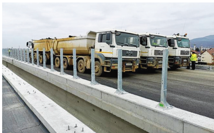
Figura 14 – Dispunerea vehiculelor de încercare pe structură poziția 1, deschiderea 2, Predeal
