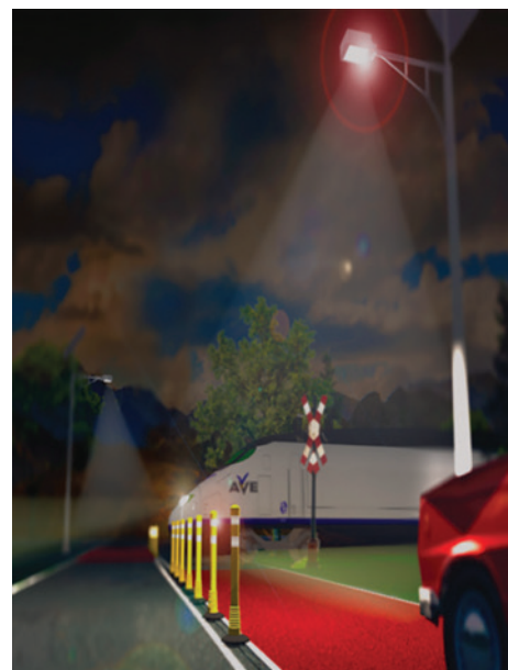
Figura 3 - Stâlp flexibil de delimitare a sensurilor de circulație
