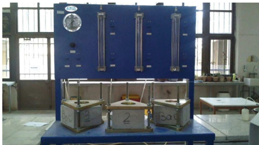
Figura 9 - Testare a permeabilității probelor de beton
