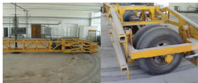
Figura 5 – Stația de încercări rutiere accelerate ALT-LIRA – Sistemul de încărcare (detalii)
