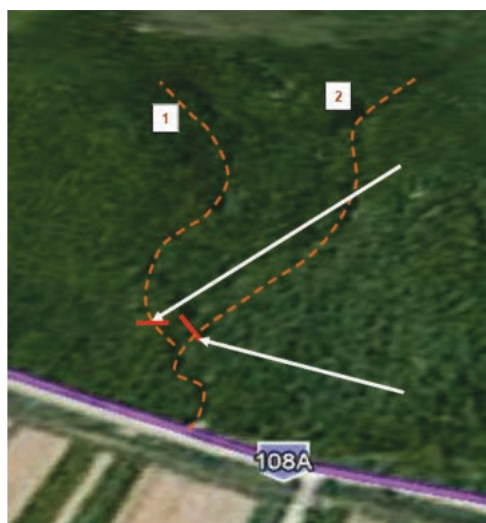
Figura 2 - Amplasare bariere torenți
