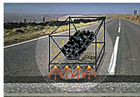
Figura 16 - Înainte de plombare, zona defectă se încălzește concomitent cu materialul de adaos până la temperatura de 160°C
