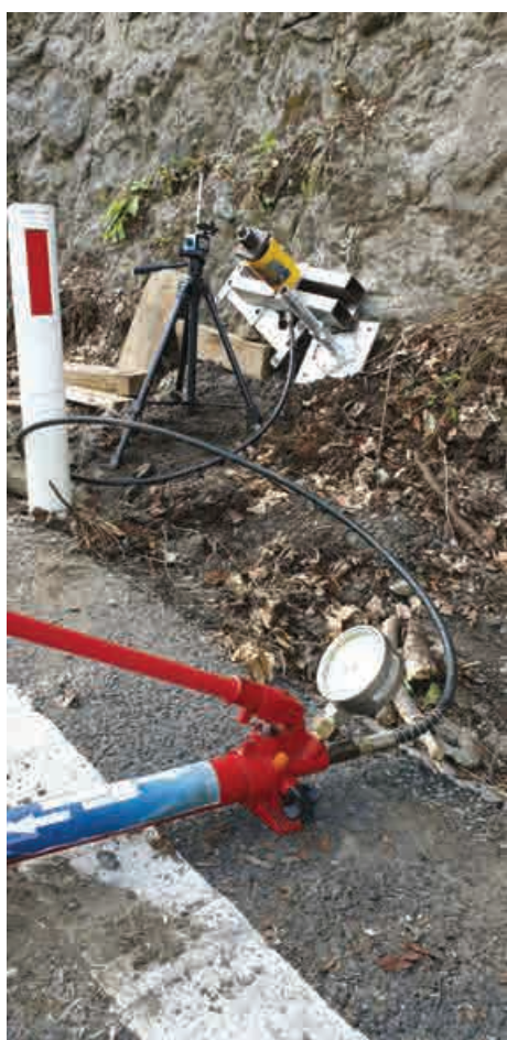
Foto 3: - Testarea la tracțiune a unei ancore aleatoriu alese
