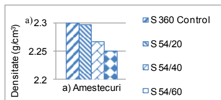
Figura 6. Densitatea, (a) cu adaos de zgură de furnal măcinată; (b) cu substituție de zgură de furnal măcinată
