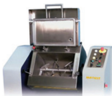
Figura 3. Malaxor pentru prepararea amestecurilor bituminoase la cald
