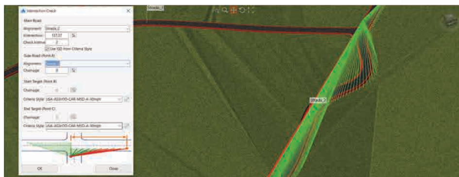
Fig. 3. Analiza vizibilității în zona intersecțiilor
