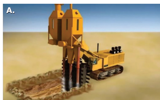
Figura 16 – Echipamente de malaxare de suprafață a pământului din terenul de fundare
