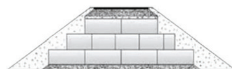
Figura 10 - Realizarea umpluturii de rambleu cu geospume
