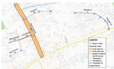
Figura 10 – Model de trafic – Intensitatea maximă orară (la ora de vârf a arterei), exprimată în vehicule etalon, estimată pentru anul 2027
