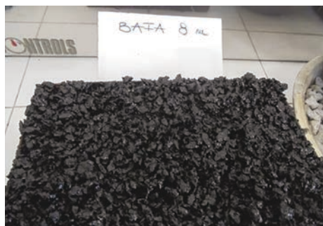
Figura 4 - Proba laborator și proba la stație a materialului fonoabsorbant
