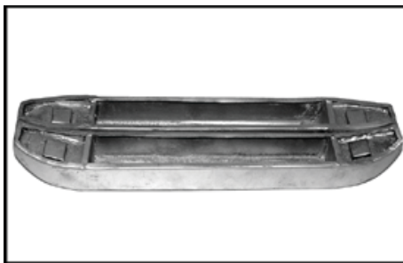
Ponton pentru fluvii model 1912
