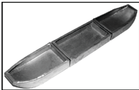
Ponton pentru fluvii model 1893
