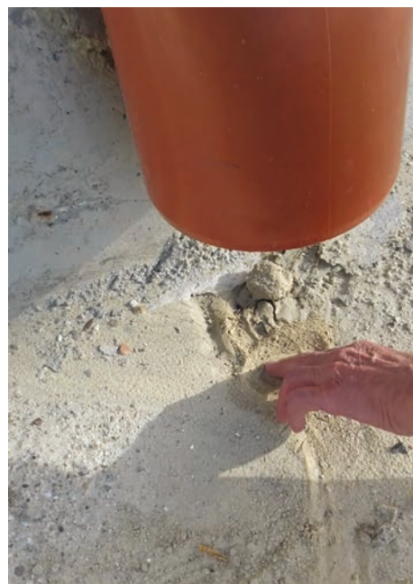
Sistem de urmărire in situ a fenomenului de „sufozie” pe DN67 km 167
