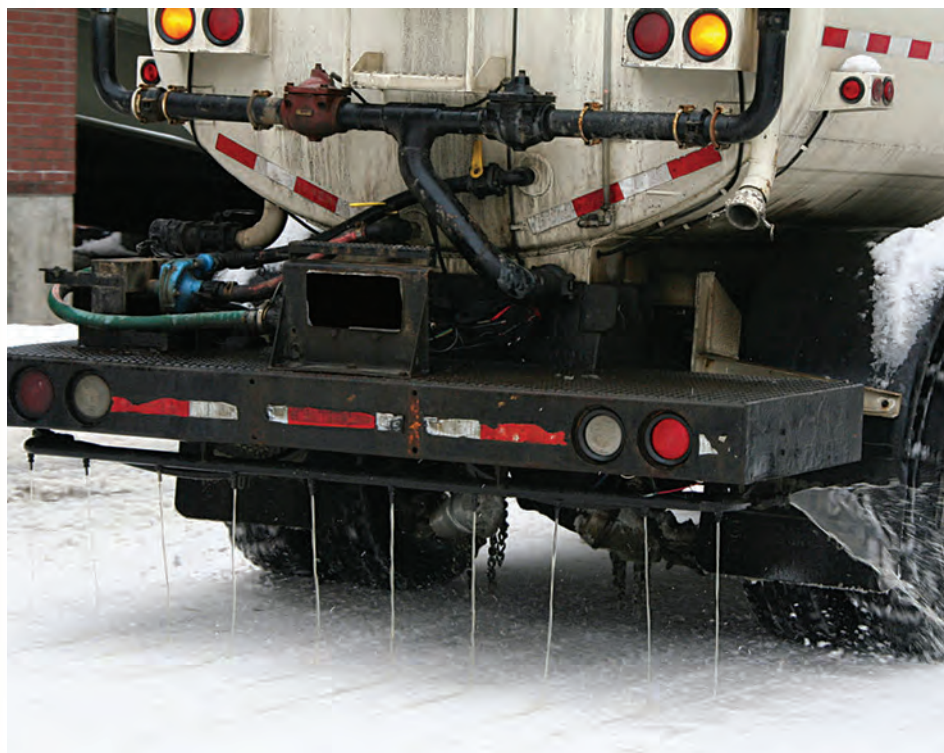
Operația de degivrare cu clorură de magneziu
