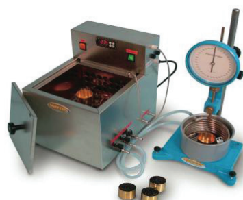
Figura 2. Aparatura de laborator pentru determinări pe bitum (de la stânga la dreapta): Aparat inel și bilă și Frass Penetrometru Richardson Ductilometru
