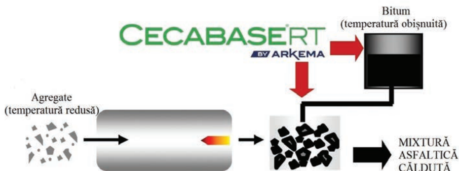
Fig. 7. Procesul tehnologic de fabricare a mixturilor asfaltice călduțe cu aditivi chimici (figură adaptată după [5])
