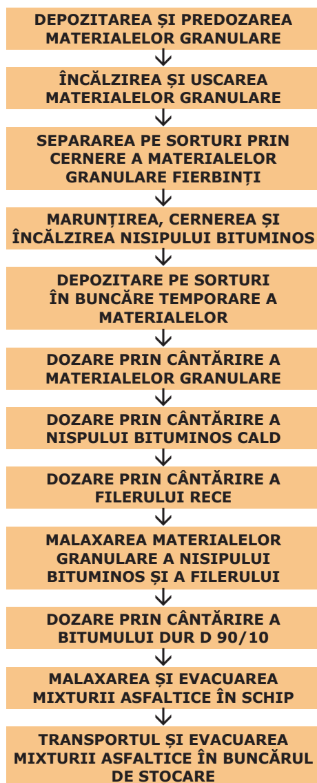
Figura 5. Etape de preparare a mixturii asfaltice cu nisip bituminos
