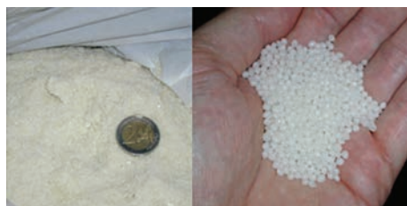
Fig. 3. Aditiv organic Sasobit sub formă de fulgi - stânga și granule - dreapta (figură preluată din [9])
