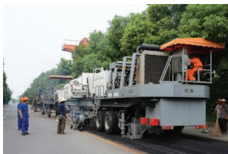
Foto 4 Trusă de reciclare a asfaltului
