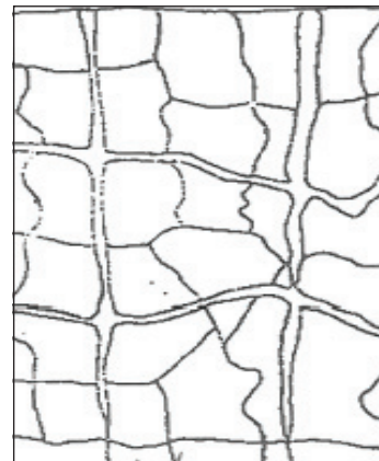
Fig. 1 - Rețea de fisuri caracteristice pământurilor contractile, conform NP 126/2010 (anexa 1, fig. 1.1)
