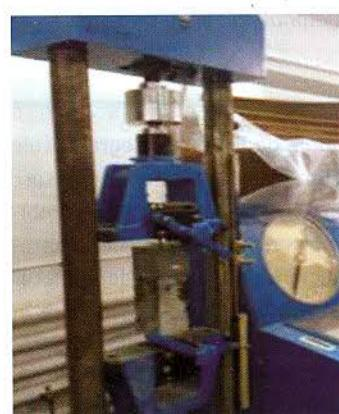
**Figura 8 - Tiparul pentru realizarea epruvetelor**
