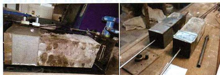
**Figura 7 - Epruveta compusă în tiparul metalic (stânga) și după decofrare (dreapta)**
