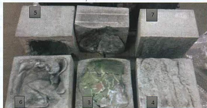
Figura 2 - Epruvete realizate cu cavități și rizuri
