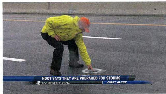
din Nevada a echipat patru poduri, de pe „Interstate 580”, cu senzori atmosferici de drum și dispozitive antiîngheț de tip spray. Chiar și utilizarea plugurilor s-a dovedit a
