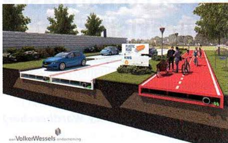
material plastic „Wavin”, au reluat cercetările pentru a realiza un prototip al unui drum construit din module de plastic. Conceptul „Plastic Road” a fost lansat, în anul 2015, de către „KWS” și își propune să utilizeze module prefabricate din deșeuri de plastic, din care să se poată realiza drumuri. Acordul prevede ca prototipul să fie finalizat până la sfârșitul anului 2017. Avantaje? Structura subterană a utilităților, ușor de realizat, avantaje ecologice, construcție ușoară etc.
