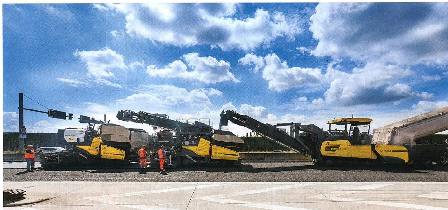
lucru este posibil datorită tehnologiei de înaltă compactare, realizată cu sistemul hidraulic unic cu debit variabil, o altă inovație dezvoltată de VÖGELE. În această etapă, asfaltul este precompactat în timpul aşternerii de către un bătător și de două bare de presiune.
