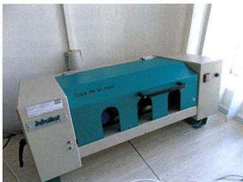
**Fig. 3 - Teste de afinitate: baloane rotative utilizate**
