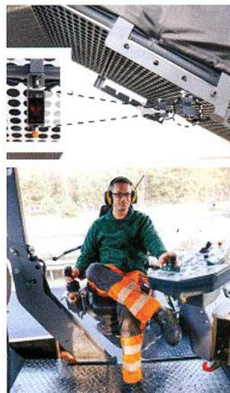
Atunci când se lucrează cu materiale extrem de abraziive non-bituminoase, modelul „SUPER 3000-2“ poate fi echipat cu un „Heavy-Duty Kit“. În plus, pentru lucrul cu lățimi mari și pentru menținerea cursului de operare, echipamentul este controlat de un sistem de direcție automat.
