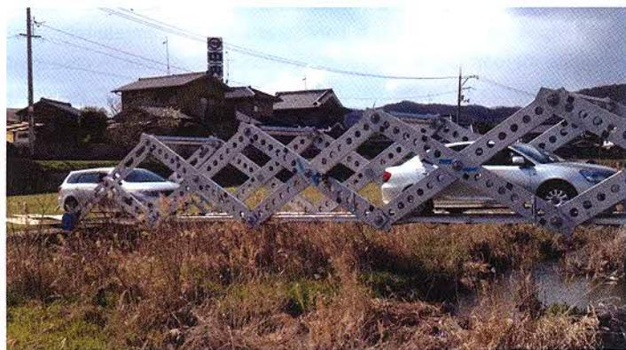
Cercetătorii Universității Hiroshima au realizat un test al unui „pod mobil” (Mobile Bridge - MB), în condiții naturale, peste un râu real. În timpul încercării, podul a funcționat fără nici un fel de fundație, cu foarte puțini oameni în jurul său, suportând și trecerea unui automobil.
