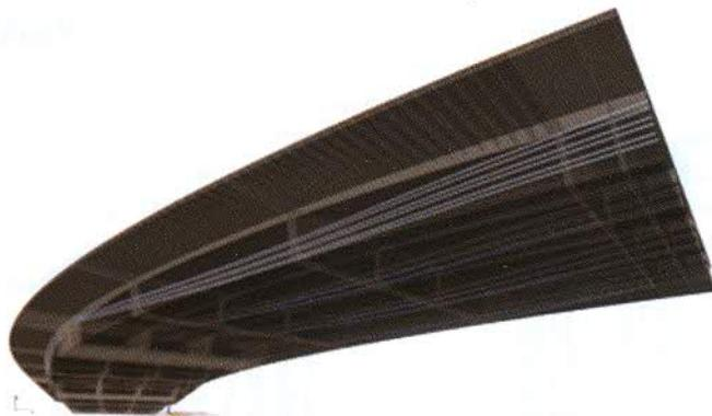
Fig. 2 - Dispunerea toroanelor 3D în Scia Engineer
