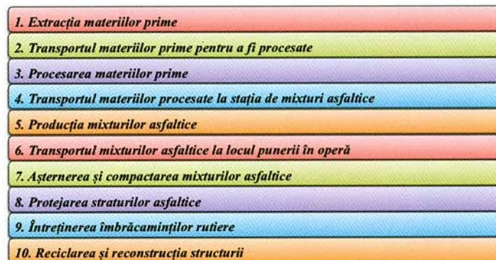
**Figura 7 - Etapele ciclului de viață ale mixturi asfaltice Cradle to Grave (TRL, 2014)**
