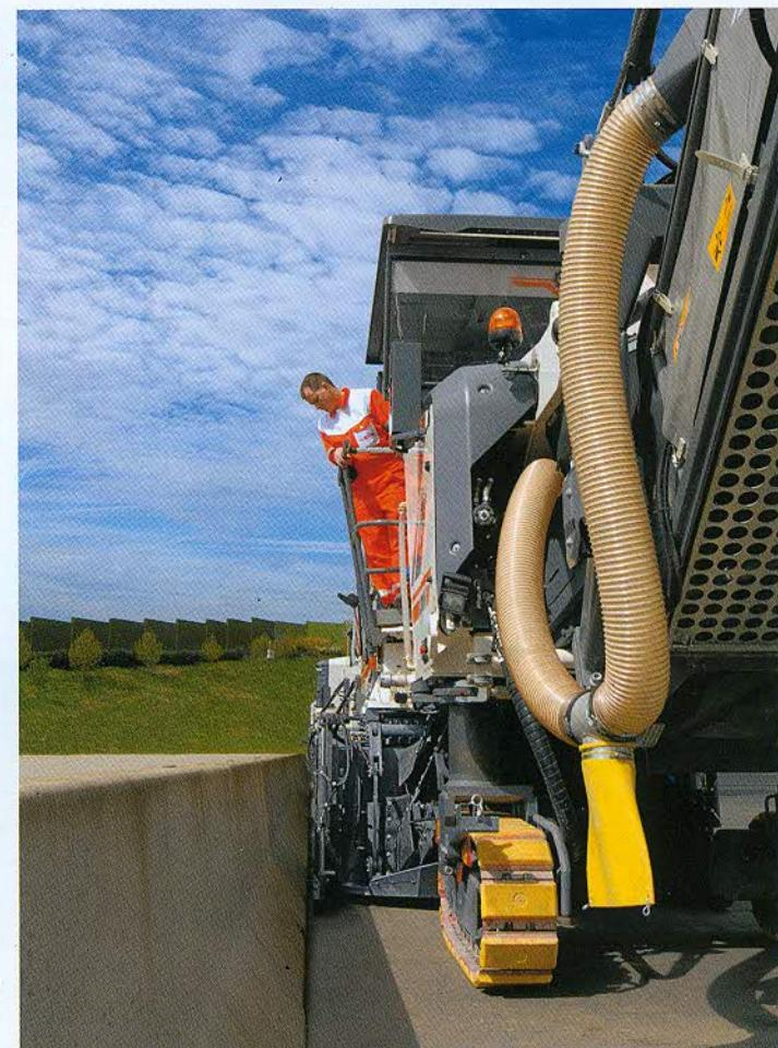
*Caracteristica principală a frezei «W 200 Hi» de la «Wirtgen»: fără margini, permite să lucreze până la marginea drumului, pe ambele părți stânga și dreapta.*
