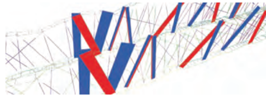
Fig. 3 – Diagrama de forță axială diagonală pod
