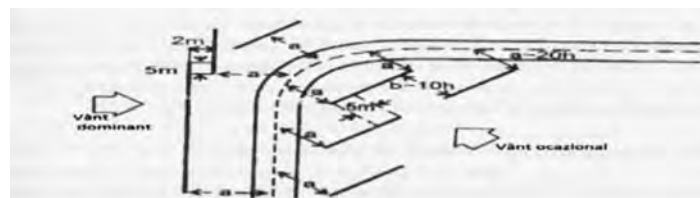
Figura 2.9. Amplasarea panourilor parazăpezi - curbe înzăpezibile -
