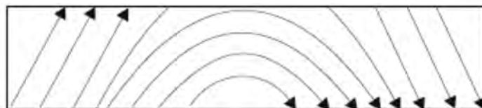
Fig. 4. Reprezentarea direcțiilor de scurgere a apei pentru un profil transversal cu pantă constantă (stânga) și pentru un profil transversal de tranziție (dreapta), ambele cu pantă longitudinală constantă
