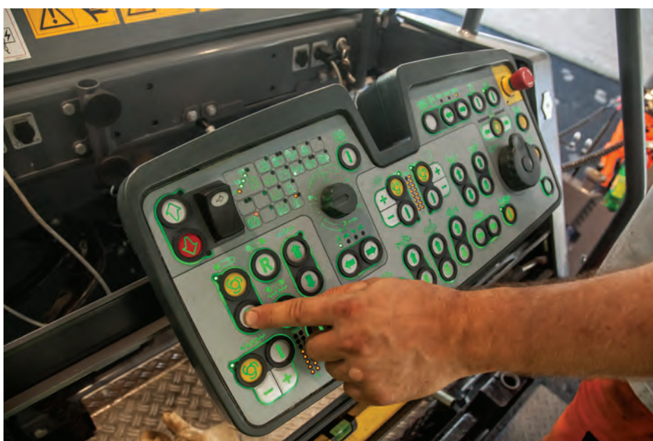
Consola operatorului ErgoBasic cu lumini integrate permite operarea în siguranță, când lumina este insuficientă
