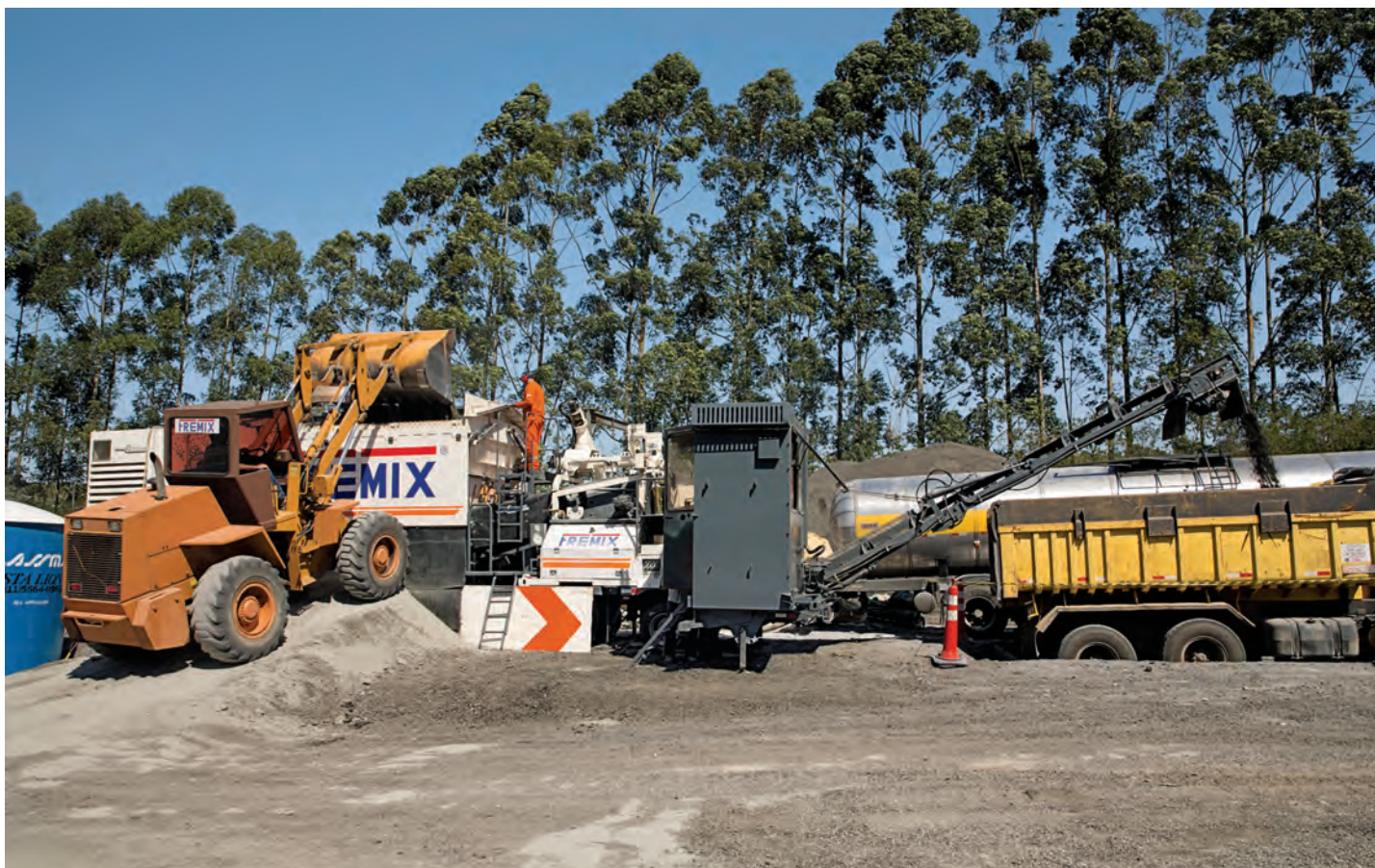
Stație mobilă de preparare mixturi asfaltice la rece cu recuperare asfalt Wirtgen KMA 220, cu o capacitate de producție de 220 t/h, la prepararea mixturii la rece cu materiale reciclate
