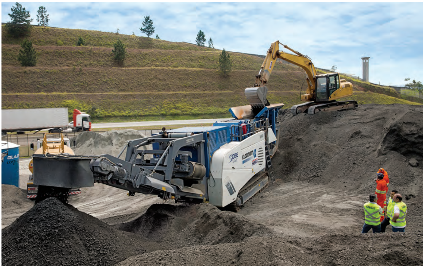
Concatorul mobil cu fălci Kleemann MC 110 Z EVO concasează asfaltul recuperat la o dimensiune a granulelor de max. 20 mm, înainte de a fi reciclat în stația KMA 220
