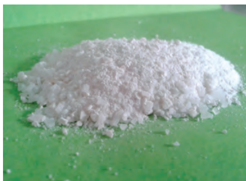
Figura 9 - Aditiv anti-îngheț Winterpav
