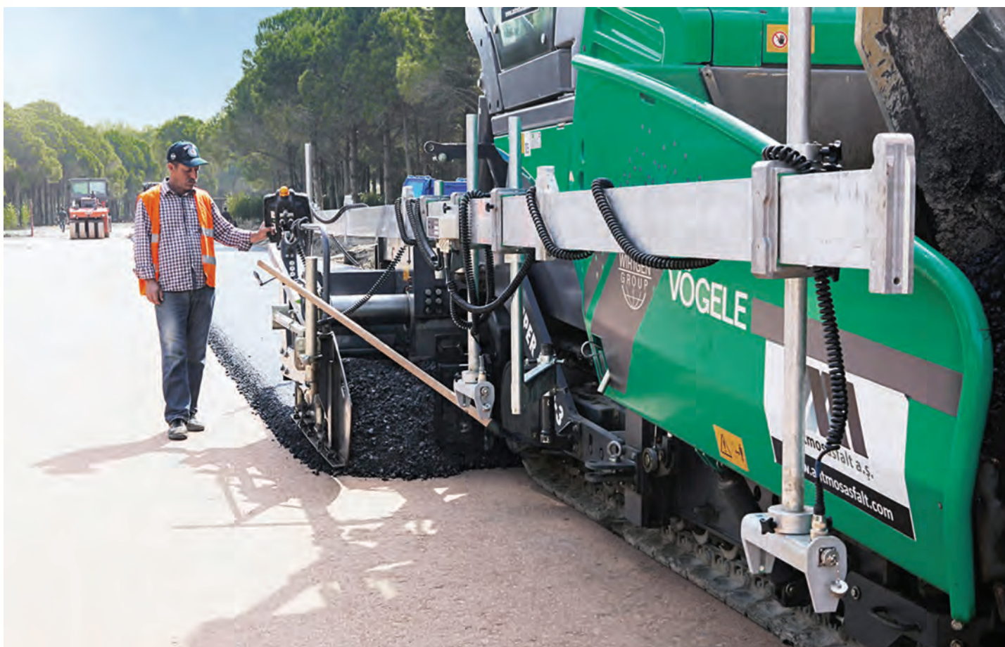
Inovație inteligentă: consola grinzii cu „SmartWheel” pentru un control precis al lății de așternere, cu două viteze de lucru
