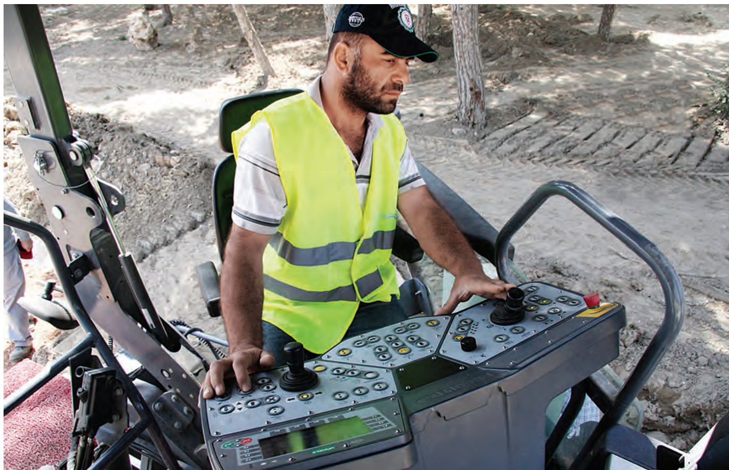
Inovație inteligentă: consola grinzii cu „SmartWheel” pentru un control precis al lățimii de așternere, cu două viteze de lucru
