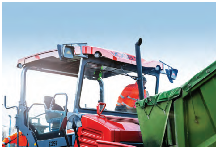
Super comunicare: Noul „PaveDock Assistant” cu semnale luminoase, amplasate pe copertina finisorului, îi oferă indicații precise șoferului camionului.
