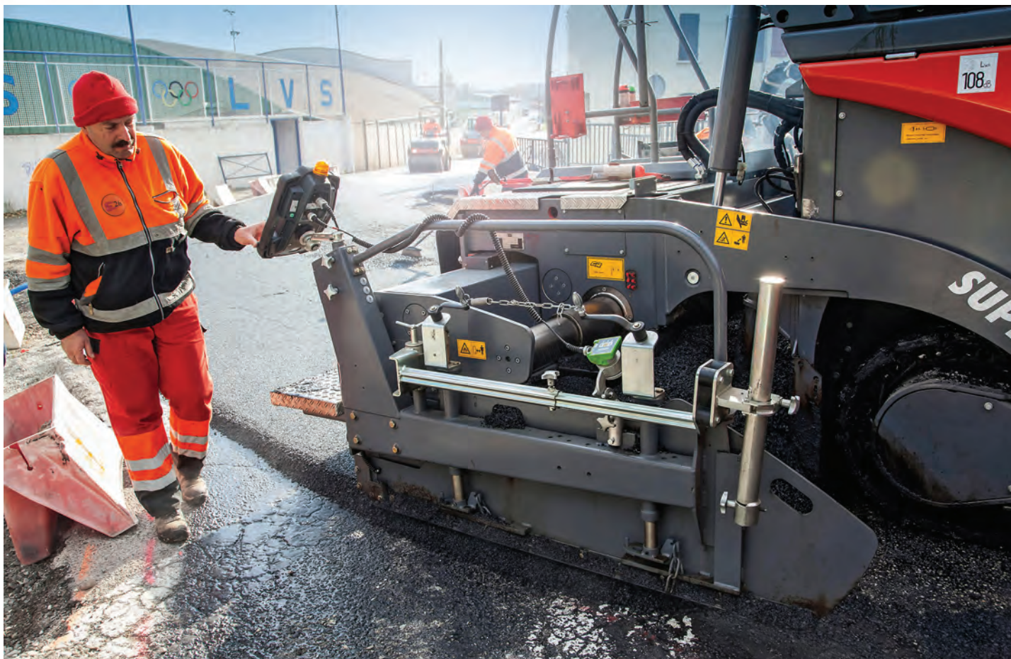
Super operare: consola de comandă a grinzii a fost reproiectată.
