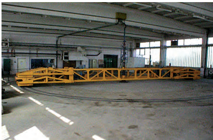
Figura 1. Vedere generală a pistei circulare de încercări accelerate ALT - LIRA din cadrul Universității Tehnice „Gh. Asachi” din Iași
