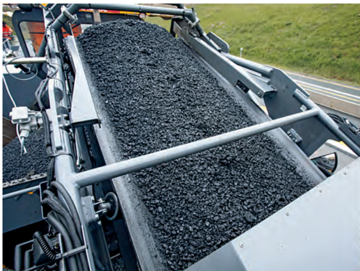
Banda „jgheab” elimină segregarea și poate fi utilizată la orice tip de material
