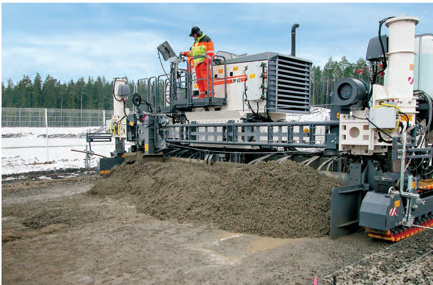
SP 82/SP 82i poate fi pre-echipat, opțional, cu un kit 3D pentru a veni în sprijinul sistemelor de comandă 3D.
