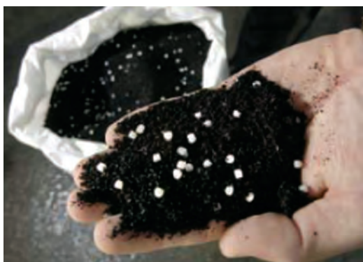
Figura 1 - Agent modificator polimeric ROAD+® (pudră de cauciuc și polioctenamer)
