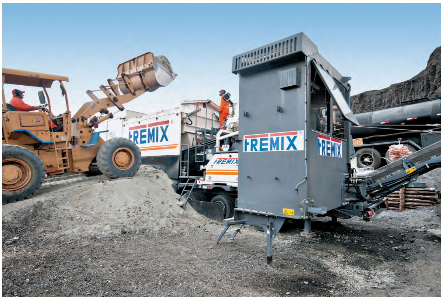
Încărcătoarele cu roți răstoarnă materialul în unitatea de dozare, prin intermediul grătarelor vibratoare. Dozarea exactă este monitorizată de un sistem de comandă al stației, bazat pe un microprocesor.
