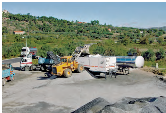
„Malaxor” mobil cu larg domeniu de aplicații: KMA 220 necesită spațiul minim și se adaptează flexibil la condițiile locale de șantier.
