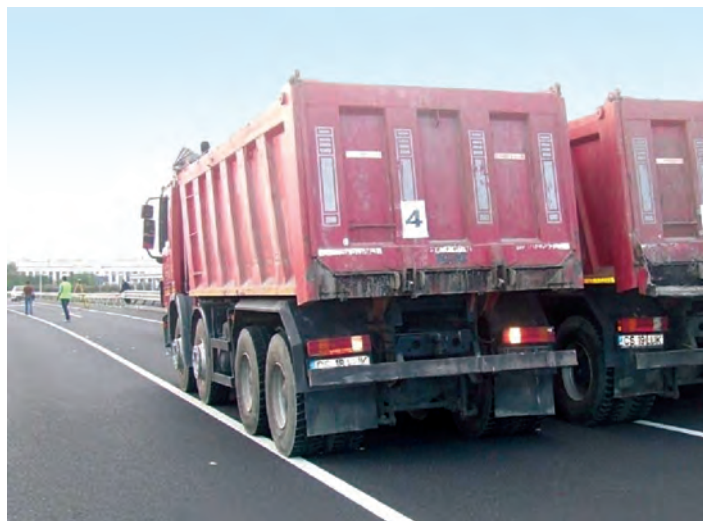
Foto 6 – Sarcina de probă amplasată excentric
