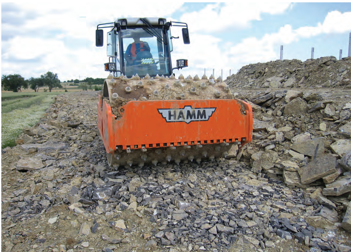
Doi în unu: Dotat cu 150 de cuțite de frezare montate pe tamburul de concasare, acest model 3625 HT VC a concasat și compactat aproximativ 50.000 de metri cubi de soluri mixte, intercalate cu calcar și ardezie naturală, pentru zona de parcare a centrului de logistică din sudul Germaniei.
