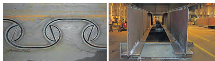
Figura 14 Grinzile metalice în uzină și conturul de tăiere
