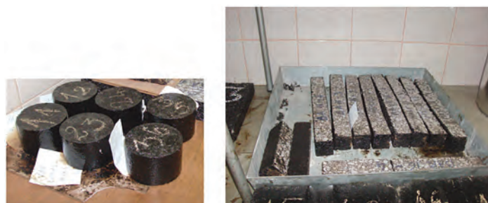
Figura 4. Probe cilindrice și prismatice supuse încercării de oboseală
