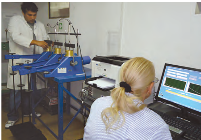
4. Aparat pentru determinarea compresibilității-edometru cu casete, soft și computer
