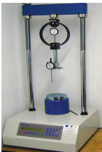
1. Aparat de compresiune monoaxială cu soft de calibrare, cu computer și imprimantă
