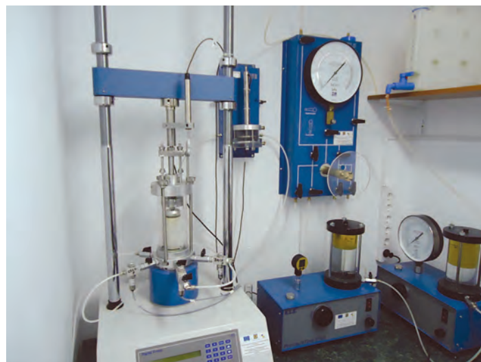
2. Aparat triaxial complet pentru toate tipurile de determinări
