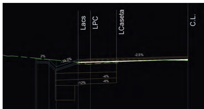
Figura 5 - Aplicare și definire casete de ranforsare
