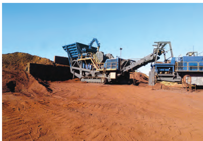
Concasorul MC 125 Z, cu o productivitate de peste 600 t/h, asigură suficient material pentru trei unități MOBICONE din aval
