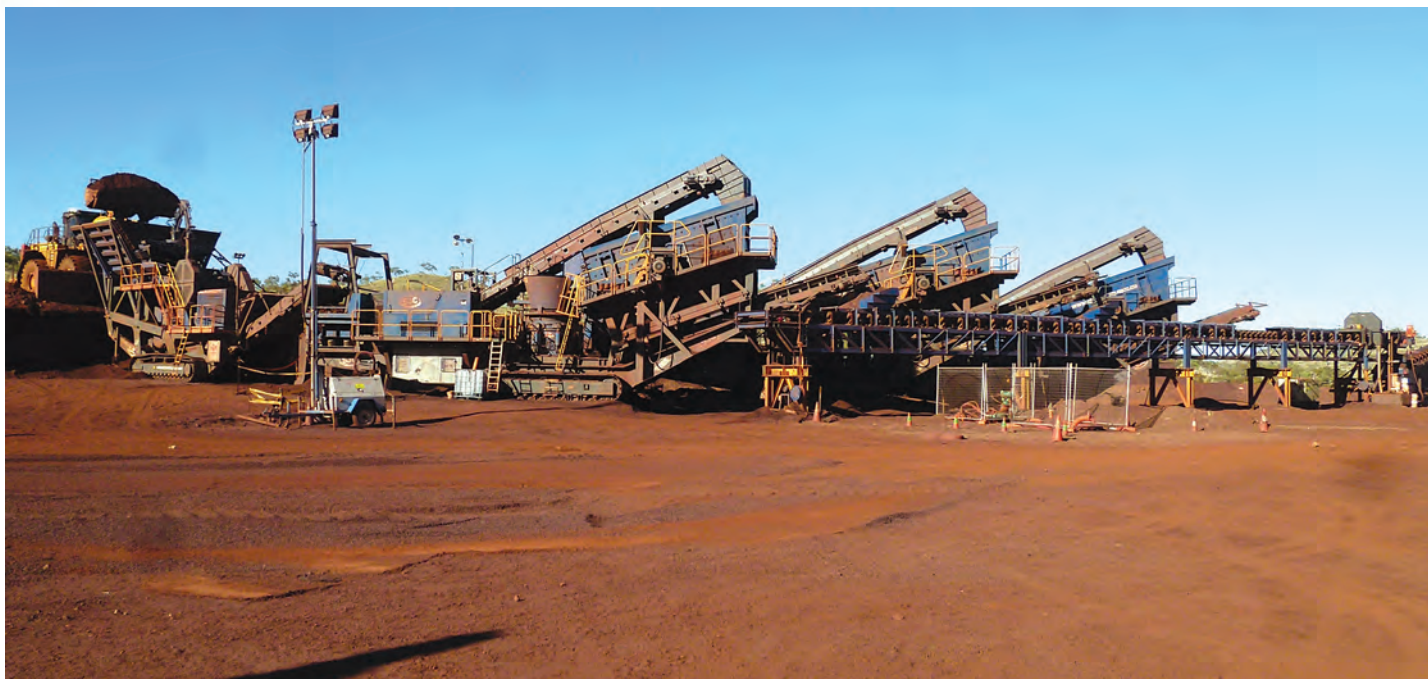
O combinație de concasare mobile cu fălci MC 125 Z, concasare mobile cu con și ciur de presortare cu trei etaje MCO 13 S, în regiunea australiană îndepărtată
