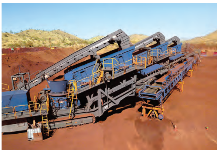
Trei concasare secundare mobile MCO 13 S producând minereu de fier cu dimensiunea de 0-10 mm
